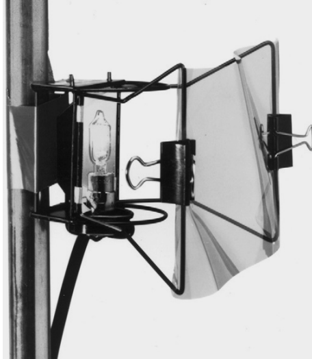
Hình 03.35: Stick-up đèn hình cao 3 inch, nặng 9 oz., dây điện nguồn 9-ft.. Nó có loại bóng 100W, 120V, hay 125W, 12V. Nó có khung dây để giữ gel và khuếch tán.
