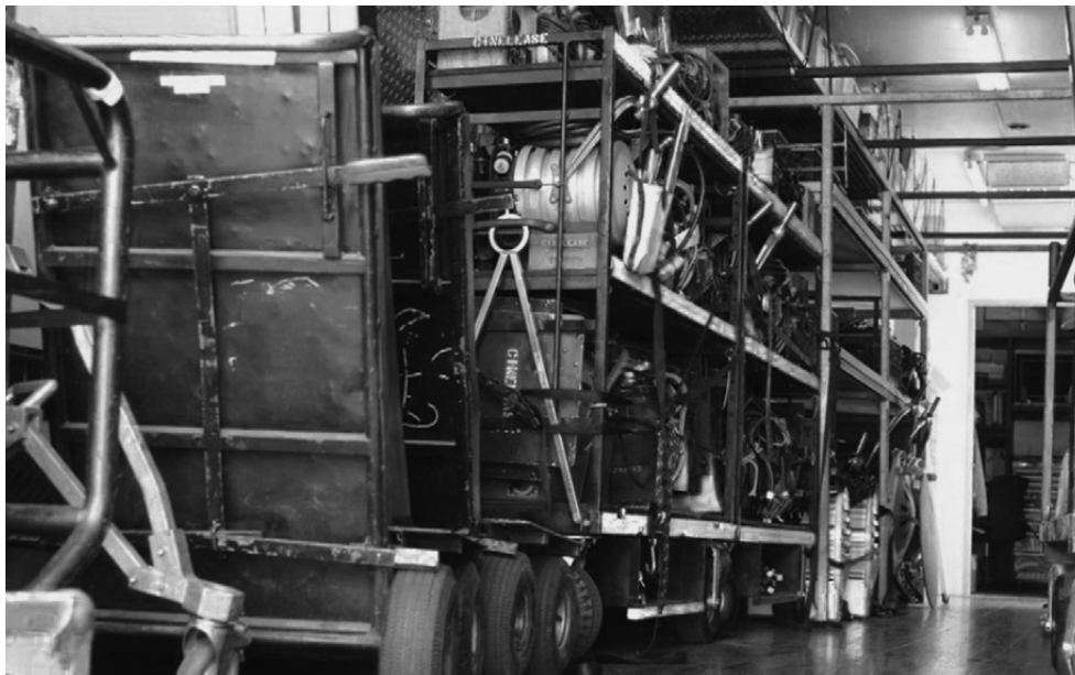
Hình 02.03: Xe tải cho chương trình có tất cả thiết bị vận tải. Lưu ý, chất và gắn đầu kéo vào tường. Hai đầu kéo chứa cable mô tả ở bên trái. Thêm vào phía trước giá đỡ xe tải chứa những đèn khác, và bộ nguồn
