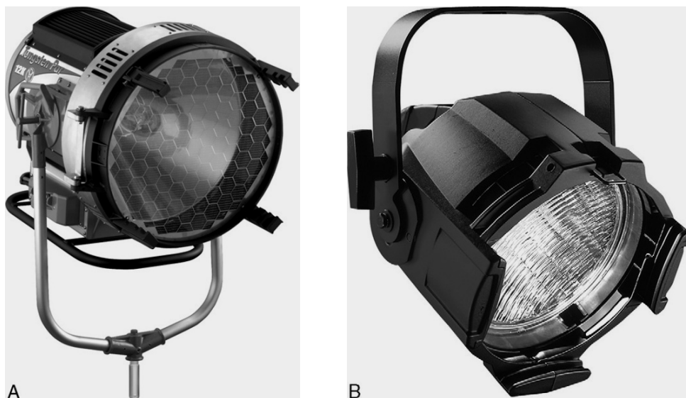
Hình 03.23: Đèn PAR gắn bóng dọc trục : (A) Mole - Richardson làm PAR tungsten 2k, 5k, và 12kW. PAR tungsten 12kW trình bày ở đây dùng nguồn 208V, cường độ 57 Amp mỗi phase. Nó đi cùng một bộ năm thấu kính có thể thay thế được, và có độ sáng tương đương Fresnel 20kW ; (B) PAR Source Four của ETC.
